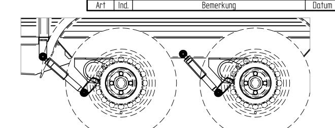
Im diesem Fall sind in der Achse Montageöffnungen vorgesehen, die es ermöglichen, einen Stoßdämpferhalter dort einzustecken und mit dem Stoßdämpfer nachträglich zu verschrauben.
