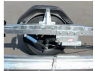
Einzelradaufhängung mit Radstoßdämpfer
